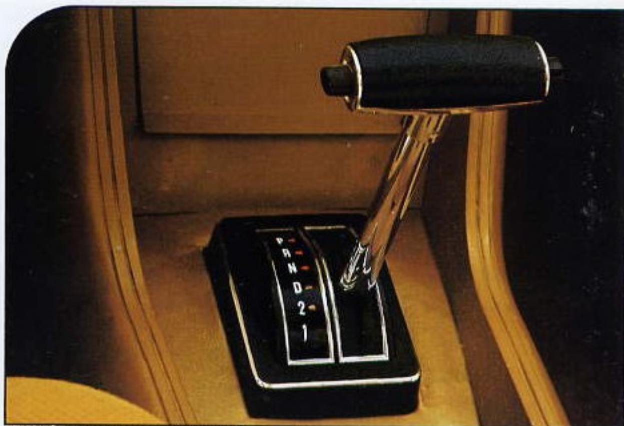
Wählhebel der Ford-Getriebe-Automatik.
