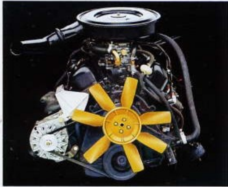
Der 3-Liter-V6-Motor leistet 138 DIN-PS.
