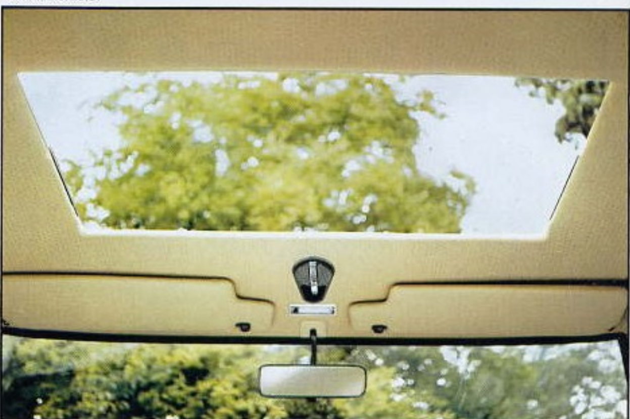
Das Hub-Kurbeldach läßt sich hinten hochstellen.
